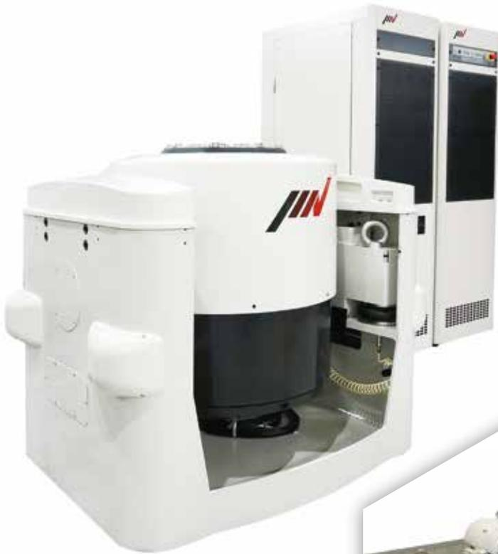
Les pots vibrants IMV répondent à l'ensemble des applications pour les essais en vibrations, les analyses structurales et modales.
